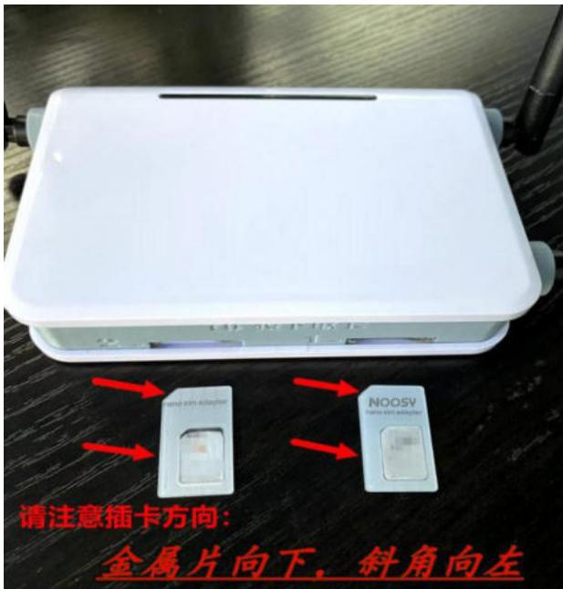
SIM 卡“**芯片向下、缺口向左**”，插入弹簧卡槽底部，听到“咔嗒”一声，即安装到位。
